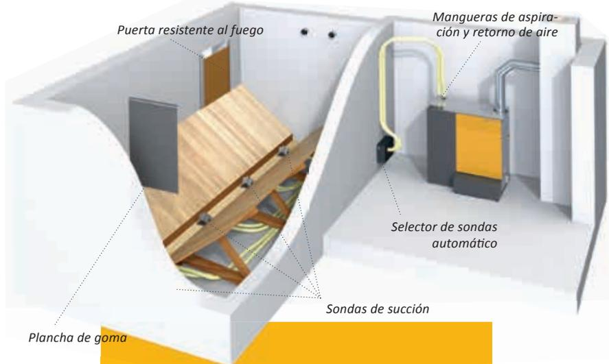
Con las sondas de succión se puede utilizar casi cualquier local como depósito, aunque no sea recto. En depósitos más grandes también se pueden instalar 8 sondas de succión.
