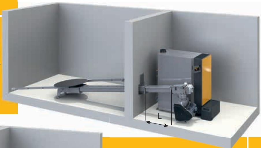
**¿Con o sin rampas de suelo?** Sin rampas de suelo la construcción del agitador de fondo es más económica. Así se asegura un funcionamiento silencioso. De todas formas una pequeña parte del depósito no se podrá vaciar automáticamente. Hay que rellenar esta parte en el primer llenado con astilla muy seca. Si decide instalar unas rampas de suelo, quedará menos astilla no utilizada en el depósito.
