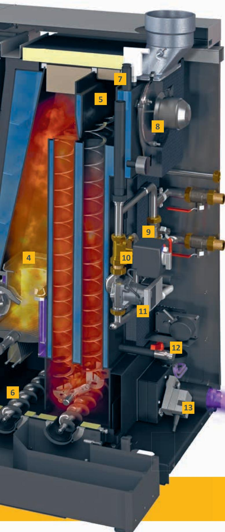
**7 Elementos de seguridad:** La caldera dispone de válvula de seguridad y sensor electrónico de presión para proteger contra presión excesiva. También tiene un purgador rápido integrado, para sacar el aire indeseado de los circuitos de calefacción. La caldera no necesita ninguna válvula de descarga térmica, ya que la cantidad de combustible dentro es tan pequeña que no hay riesgo de sobrecalentamiento.
