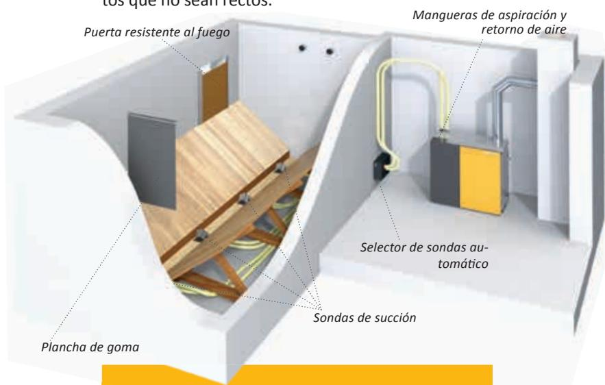
Con las sondas de succión se puede utilizar casi cualquier local como depósito, aunque no sea recto.
